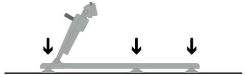
Les pieds en caoutchouc doivent être réglés pour faciliter le placement dans des baignoires incurvées. Pour cela, tourner les pieds dans le sens horaire ou anti-horaire en fonction du réglage requis.
