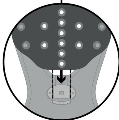
Avant d'attacher le bras d'inclinaison sur le dossier, vérifier qu'il est dans sa position la plus haute.
