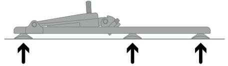
Placer le Splashy sur le côté et détacher l'assise du dossier en la renversant pour dégager le mécanisme à charnière.
